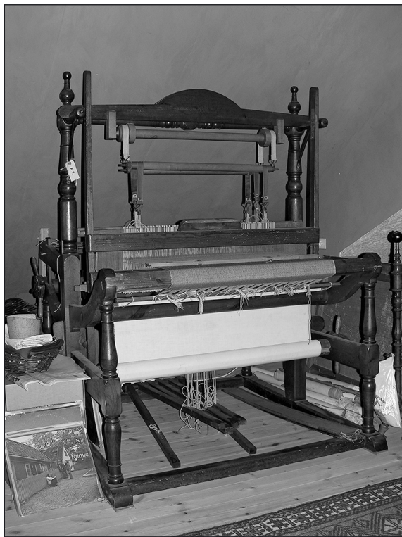
Lervadvæv fra 1897. Det er væv nr. 3 i det allerførste katalog fra Lervad. Væven er forsynet med ruller i stedet for trisser. Det gør den meget mere funktionel, og den har et fint skel.
