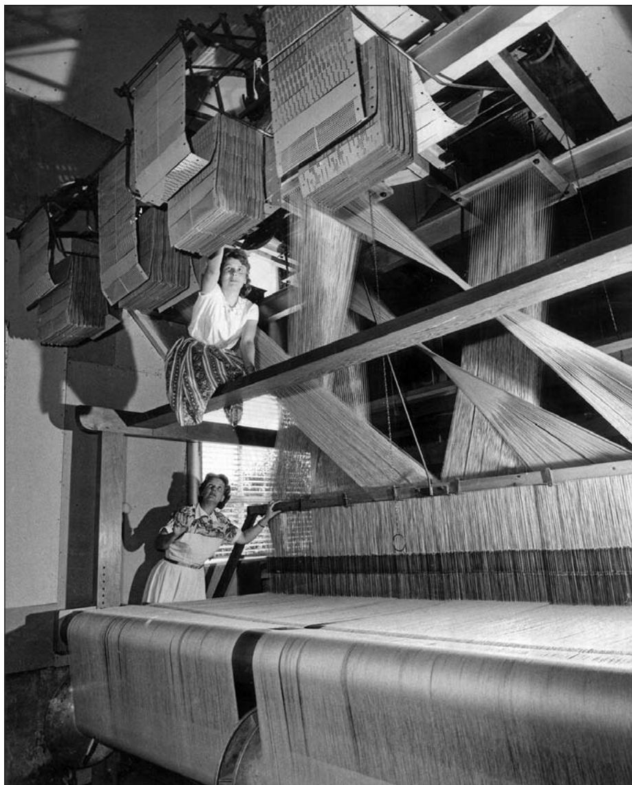
Væven set fra trendbommene/tromlerne i 1961 med barnisktrådene gennem kordbrættet til de fire jacquardmaskiner øverst på jernbjælkerne. Hele arrangementet var 5,5 m højt. Nederste Solvejg Hørbye, øverste Lis Hansen.
